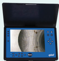
QBE-02 Bedieneinheit mit 8" Farbmonitor
